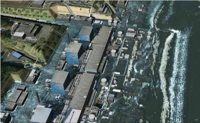
図6 東日本大震災における福島第一原子力発電所への津波遡上の再現シミュレーションと可視化
