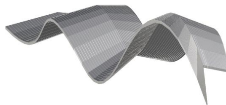
図1 可展面を接続したシェル構造
